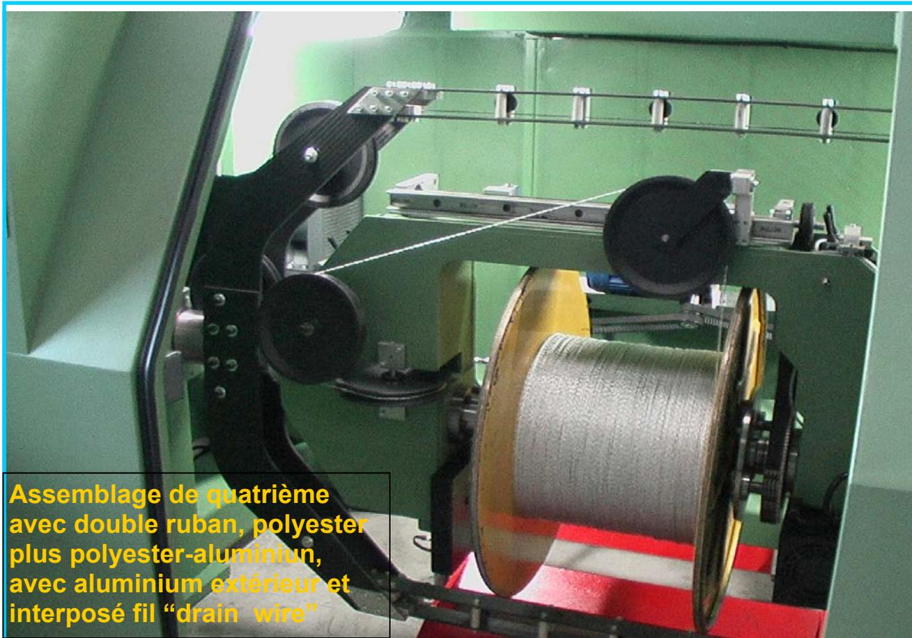
**Assemblage de quatrième avec double ruban, polyester plus polyester-aluminium, avec aluminium extérieur et interposé fil "drain wire"**
